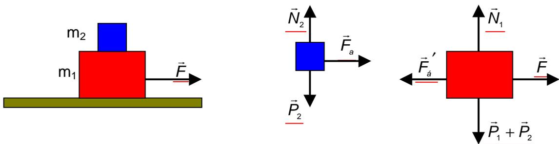
Como foi mencionado, quando mantemos o bloco de baixo fixo, uma força horizontal de pelo menos  $T = 12 \text{N}$  deve ser aplicada ao de cima, para que ele inicie um movimento. Isso significa que a força de atrito estático máxima entre os dois blocos tem esse valor.
