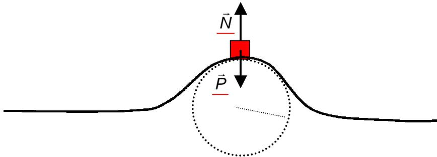
Quando uma carro perde o contato com o solo a única força que permanece atuando nele é o seu peso. Mas quando ele está prestes a perder o contato a força normal já é nula. Neste problema a trajetória é circular e nessa situação limite descrita pelo enunciado a força centrípeta é o seu peso:
