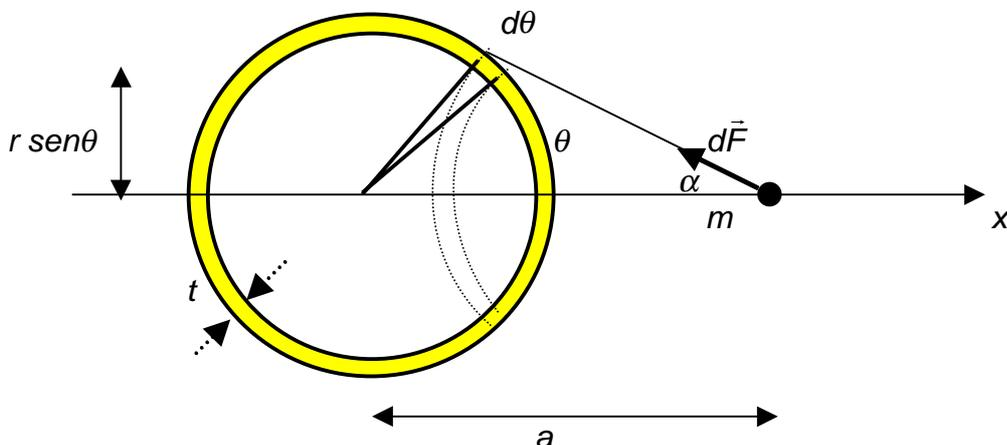
A força elementar  $d\vec{F}$  tem componentes  $x$  e  $s$ , onde a componente  $s$  está no plano perpendicular ao eixo  $x$ . Ou seja:
