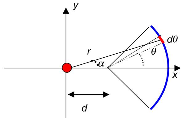
O elemento de massa  $dM$  está a uma distância  $r$  da massa  $m$  e a reta que os une faz um ângulo  $\alpha$  com o eixo  $x$ . A força entre  $m$  e  $dM$  está na direção da reta que une essas duas massas e tem a forma:
